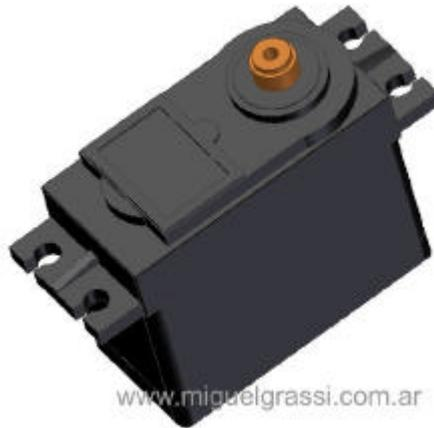
Su principal característica es la posibilidad de posicionar sencillamente, mediante una señal eléctrica de control, su eje en cualquier ángulo deseado de su rango, que usualmente va desde  $-90^\circ$  a  $+90^\circ$ . El servo alcanzará esa posición de manera automática y sin necesidad de control de nuestra parte, y la mantendrá fija, aún ante perturbaciones externas, hasta que reciba una nueva señal para cambiarla.
