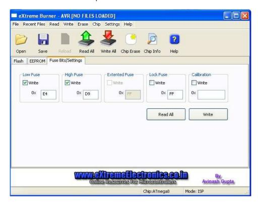
Clickear el botón Write para grabar los Fuses en nuestro micro. Aguardar la confirmación y una vez grabados, desmarcar los check boxes para evitar errores futuros.
