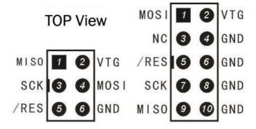
Como vimos en clase, se usa un cable plano de 10 conductores de los cuales se toman sólo 6, descartando el pin número 3 (NC-No Conectado) y tres cualesquiera de los cuatro GND.
