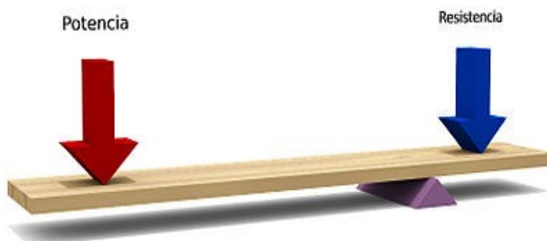
Figura 3: Palanca de 1er género. El fulcro está entre la Potencia y la Resistencia
