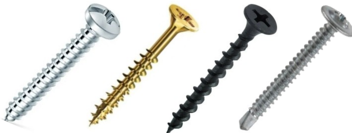
Figura 21: Tornillos Autorroscantes, de Izquierda a derecha: tipo Parker, Tirafondo para madera, Autoperforante "punta aguja" y Autoperforante "punta mecha"
