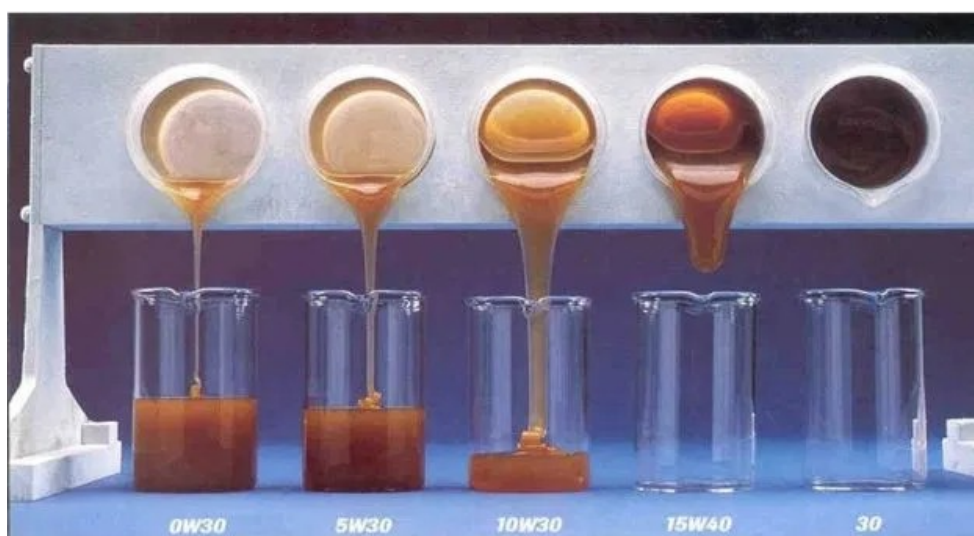
Figura 17: Medición de los grados SAE de los lubricantes
