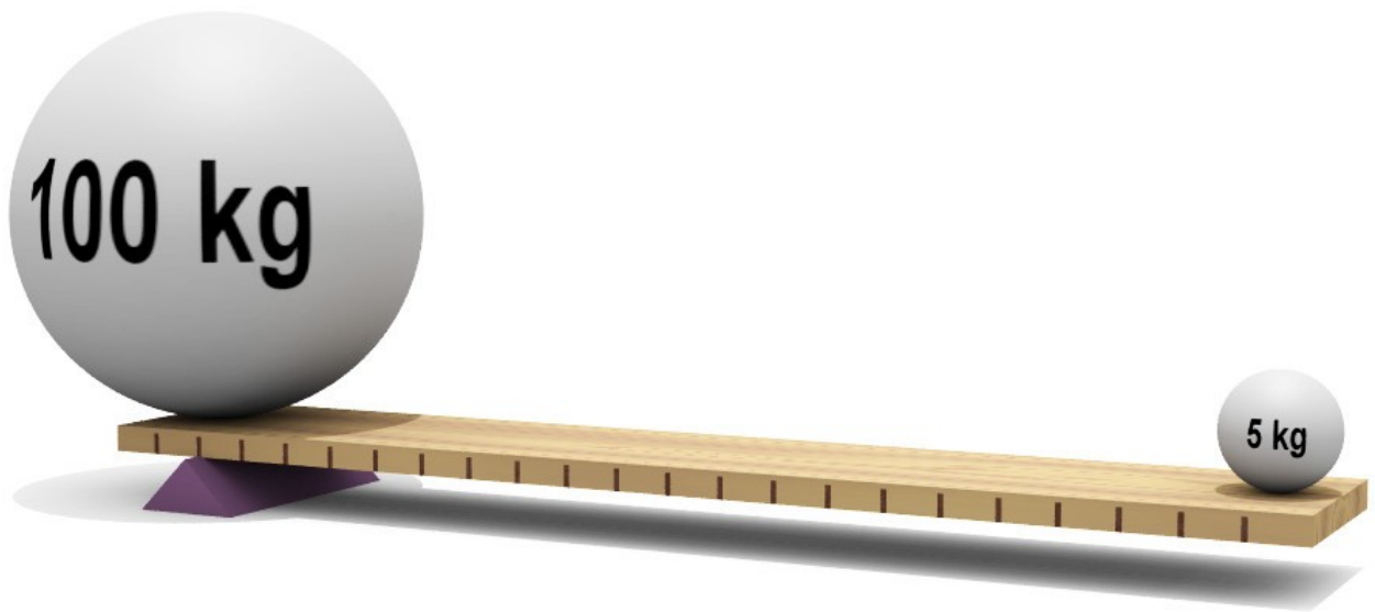
Figura 1: Ejemplo de Ventaja Mecánica en una palanca de 1er género
